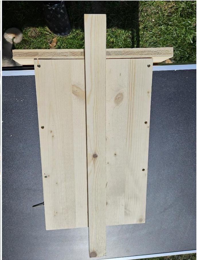
**Dach** oben aufsetzen, mit **leichter Überlappung** links, rechts und vorne
